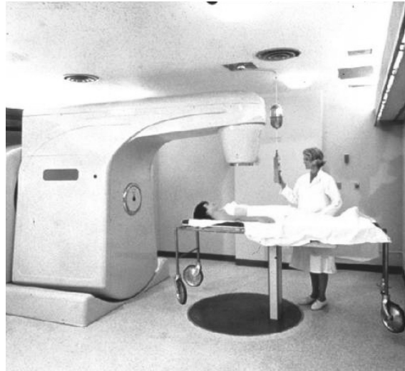
図2 最初の360度回転ガントリー式6 MeV 医療用リニアックシステム
