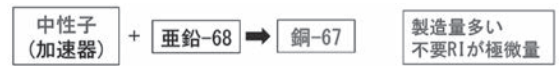
図2 加速器からの中性子を亜鉛-68試料に照射して銅-67を製造する方法とその特徴(我が国独自の製造方法です)
