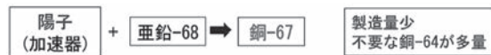
図1 加速器からの陽子を亜鉛-68試料に照射して銅-67を製造する方法とその特徴
