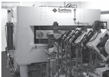
図3 加速器（左図）及び重陽子を炭素板に照射して中性子を発生する模式図（右図）
